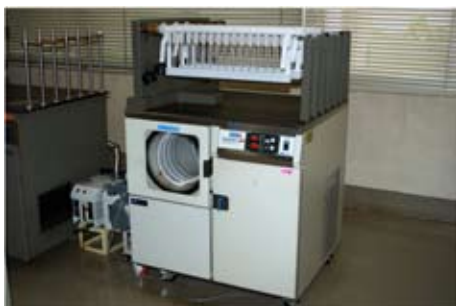
Freezing-dryer (Pat. S59-141735)
